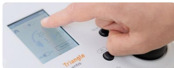
Bell es un audiómetro de diagnóstico básico, capaz de realizar exámenes rápidos y precisos del umbral de conducción aérea y ósea. Su sencillo funcionamiento, un modo de examen automático rápido y fiable, una interfaz fácil de usar y su fácil portabilidad hacen de Bell el instrumento ideal para clínicas privadas, clínicas multiespecialistas y aplicaciones de medicina del trabajo.
