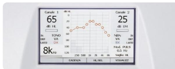
Harp es un audiómetro diagnóstico avanzado, capaz de realizar exámenes audiometricos rápidos y precisos de conducción aérea, ósea y del habla, así como varios exámenes adicionales, incluyendo QuickSIN™ y un audífono maestro de dos canales. Características de nivel superior combinadas con facilidad de uso y portabilidad hacen de Harp la elección ideal para una amplia gama de usuarios, desde audiólogos hasta clínicas y hospitales.
