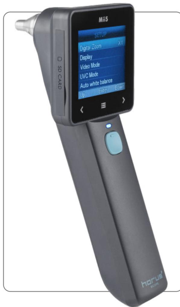
\_\_\_Video Otoscope H è un video otoscopio digitale portatile, ergonomico e compatto, estremamente facile da trasportare. Il dispositivo comprende la telecamera, l'illuminazione a LED, il display e la batteria ricaricabile.
